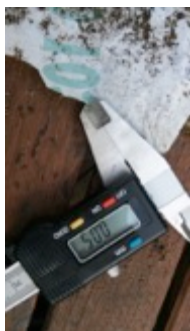
Mesura del gruix d'una bossa de PEAD amb peu de rei
